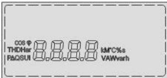
In der zweiten Zeile des Displays werden die Einstell- und Messwerte mit den zugehörigen Einheiten angezeigt. Im Falle eines Alarms, wird hier ein Alarmcode angezeigt. Alle möglichen Alarmcodes sind in der Tabelle auf der nächsten Seite aufgeführt und erläutert.
