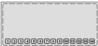
In der untersten Zeile werden aktive Ausgangsrelais angezeigt.
